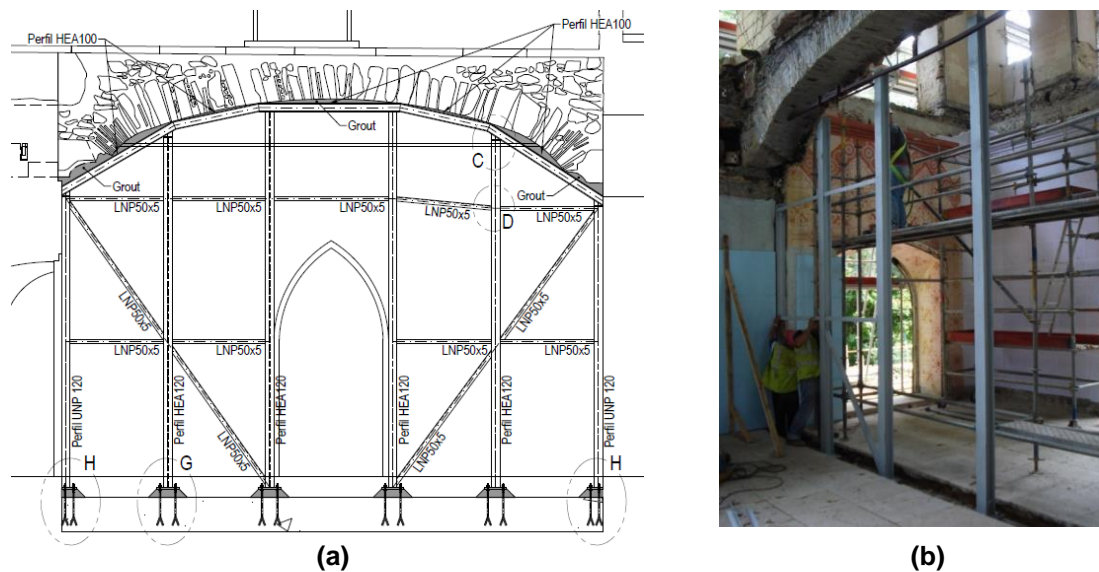
Figura 3.12 - Consolidação estrutural do arco N-S de maior vão: (a) representado em Autocad e (b) em obra (créditos CivilSer e PSML, respetivamente)
