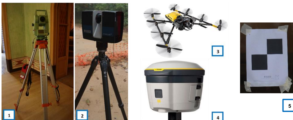
Figura 4.2 - Equipamento usado para o levantamento de campo do Chalet (1- estação total Leica TCR 703; 2- Laser Scanner Faro Focus S70; 3- Drone Topcon Falcon 8+; 4- Recetor GNSS Trimble R2; 5- Alvo plano)
