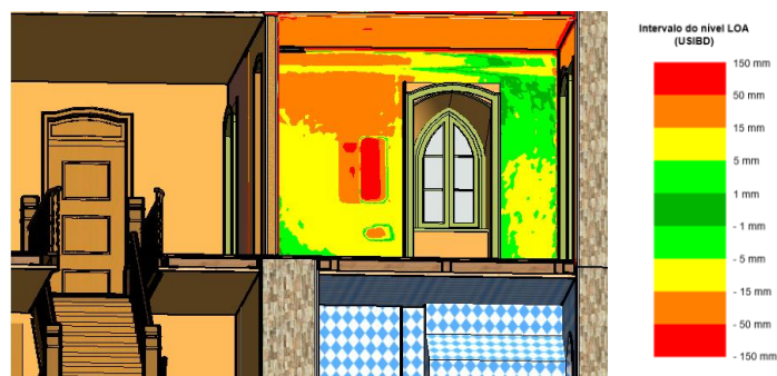
Figura 4.11 - Padrão do nível de precisão (USIBD, 2019) de uma das paredes do escritório do Rei, calculada através da ferramenta Surface Analysis
