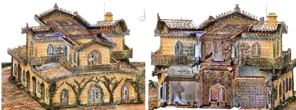
Figura 4.6 - Nuvem de pontos do Chalet da Condessa d'Edla, no software Revit
